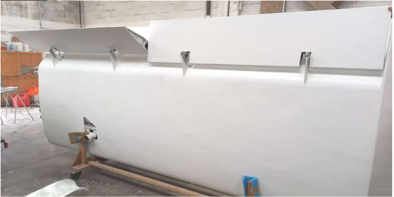
Pose des ferrures d'ailerons et volets sur le RL19. L'aile complète est enfin assemblée avec ses parties mobiles.
