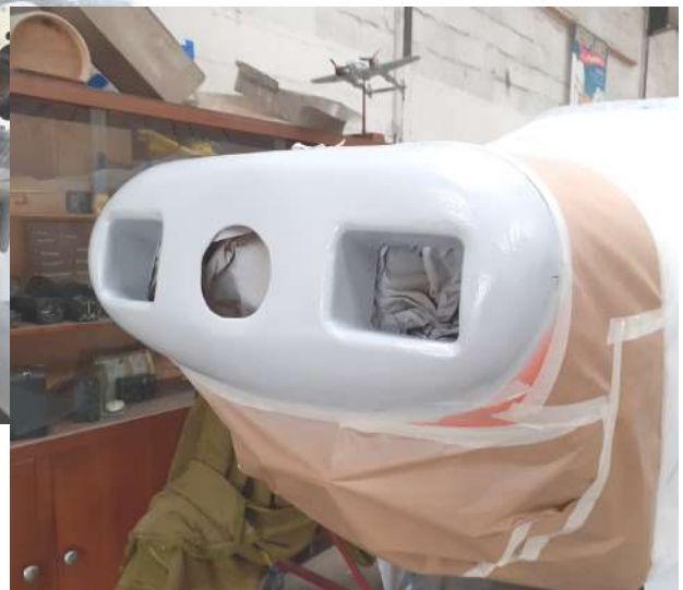
Le capot du RL 19 paré pour la peinture, après finition et couches d'apprêt garnissant.
