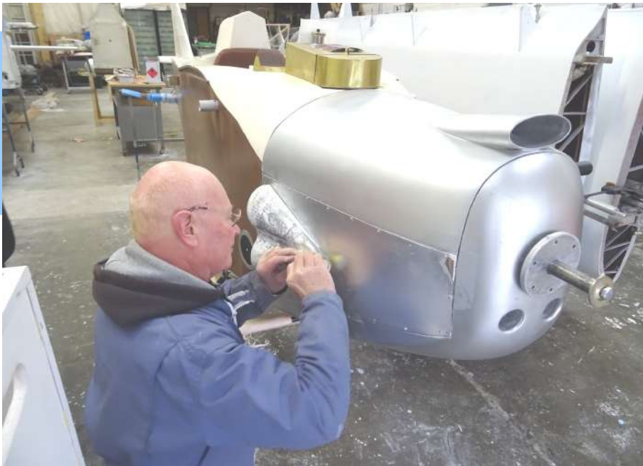
On rectifie les ouïes de sortie d'air sur le capot de l'avionnette PEYRET, pour les rendre plus conformes à l'original. On en profite pour réajuster le capot et le repeindre.
