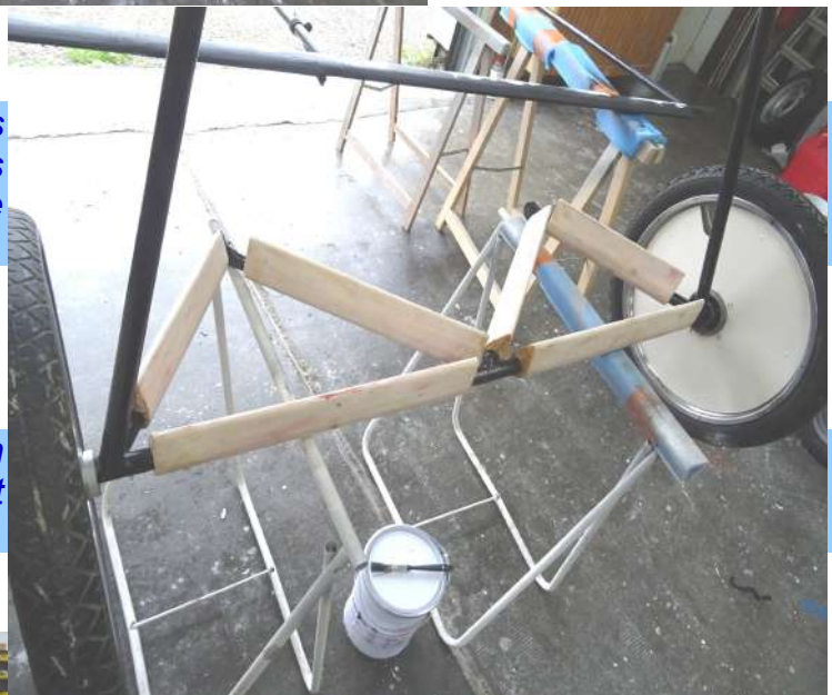
Mise en place et marouflage des profilés sur les haubans et les jambes de train de l'avionnette. Le tout est repeint en noir mat.
