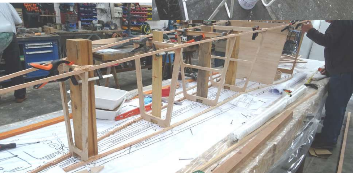
Ci dessous : naissance de l'alérion avec la pose des premiers cadres et premières lisses.
