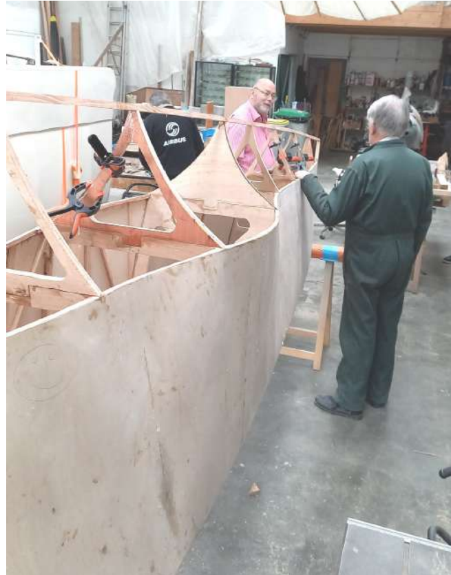
Quelques étapes du chantier « alerion », à ses débuts, et lors de la pose des flancs en contre-plaqué. On remarque les courbes particulières du fuselage, avec le renflement au niveau du poste de pilotage, qui rendent très délicate la réalisation des revêtements.
