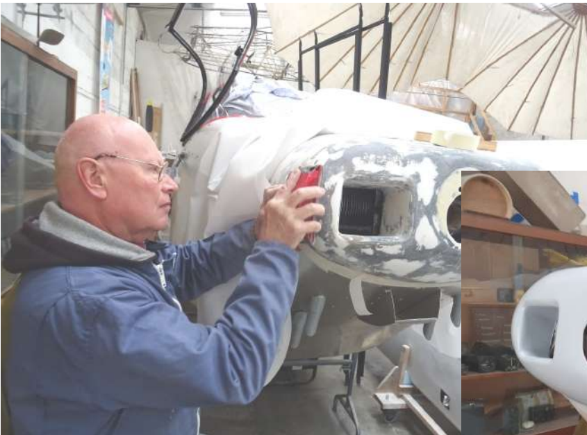
Le capot du RL 19 paré pour la peinture, après finition et couches d'apprêt garnissant.
