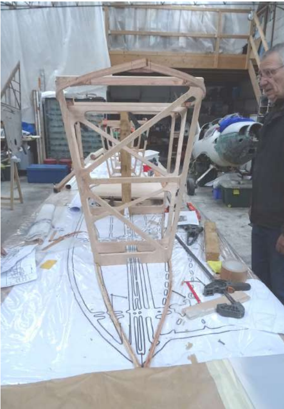
Quelques étapes du chantier « alerion », à ses débuts, et lors de la pose des flancs en contre-plaqué. On remarque les courbes particulières du fuselage, avec le renflement au niveau du poste de pilotage, qui rendent très délicate la réalisation des revêtements.
