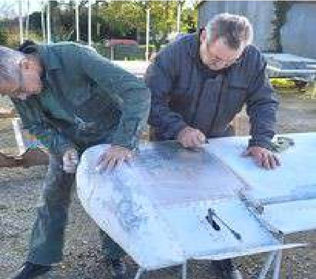
Travail de finition sur une aile du DG1
