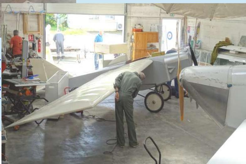
Une grande satisfaction : la mise en croix du RL19 pour la première fois depuis le début des travaux de restauration. La conception et la fabrication d'un chariot de manœuvre spécifique a grandement facilité le montage des ailes et du train d'atterrissage. A droite : montage de l'aile droite.
