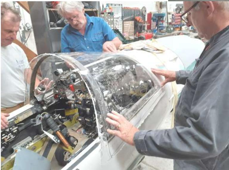
On procède à des essais de verrière sur le DG1. Ce moulage d'une bulle de forme non développable reste une tâche très difficile à réaliser correctement avec des moyens amateurs, et hors de prix si on la commande à un professionnel.
