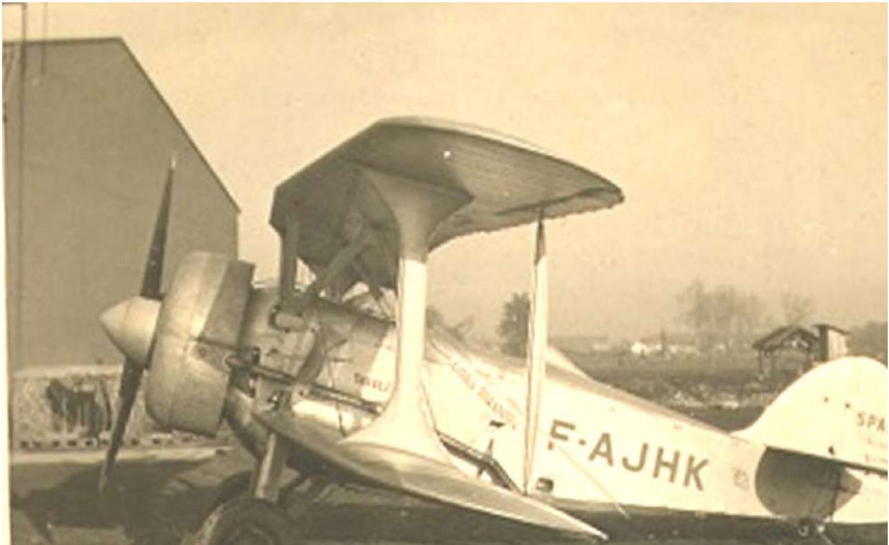
Le Blériot-Spad 92/4 est l'ultime évolution du S-92/0 avion biplace de sport ayant fait son 1<sup>er</sup> vol le 21 Août 1928 propulsé par un moteur Hispano 8Ab de 180cv. Il porte le numéro de série 4432.15. Propriété de la SA Blériot Aéronautique basée au Buc il effectue de nombreuses présentations aux mains du célèbre pilote Louis Massotte, compagnon du grand Marcel Doret. Par la suite il est transformé en Spad 92/2 et équipé d'un moteur Salmson 9 cylindres en étoile de 230cv.
