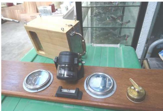
*Un projet d'équipement de bord plausible sur l'avionnette. L'anémomètre et l'altimètre s'imposent, ainsi que le barographe, Restera à discuter la présence d'un compas, d'un compte-tours et d'un indicateur de pression d'huile. Ces deux derniers sont mentionnés dans la documentation d'époque comme nécessaires à la conduite du moteur Sergant.*
