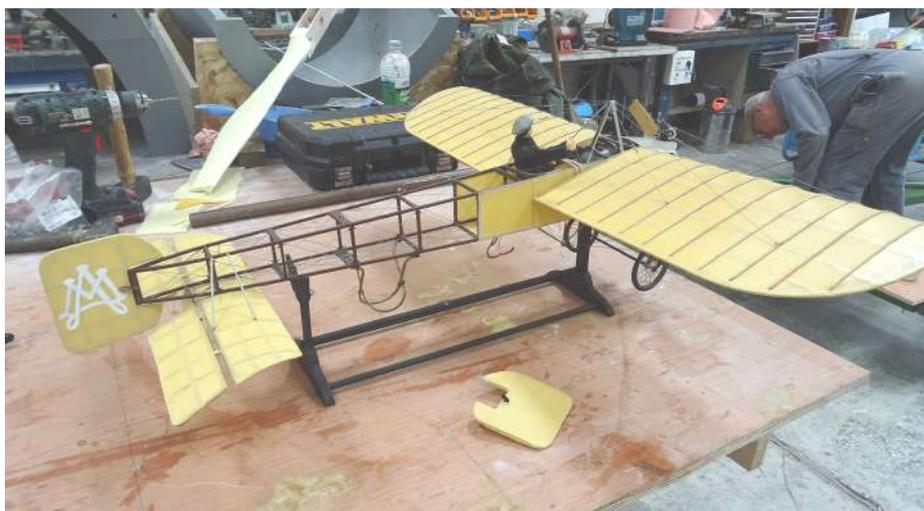
Version simplifiée et allégée du Blériot XI, type « traversée de la Manche. Ce monoplace est propulsé par un moteur Anzani « en Y inversé » de 35 cv, contrairement au Blériot XI équipé d'un moteur en éventail moins puissant.
