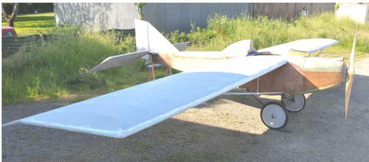
*L'Avionnette PEYRET mise en croix sur le parking de l'atelier, pour la première fois le 17 mai. On distingue le réservoir en laiton, sur le capot devant le pilote. La plupart des éléments de l'appareil ont reçu une couche d'apprêt. Nous allons passer rapidement à la finition et à la décoration.*
