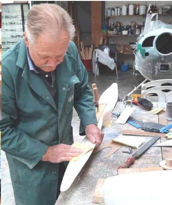
Les extrémités de pales sont mises à la cote et l'ensemble est finement râclé, puis poncé.
