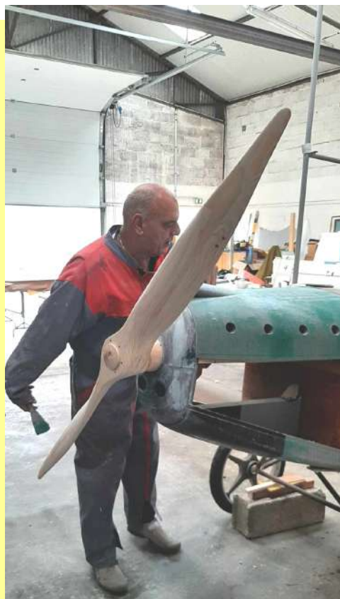
Les extrémités de pales sont mises à la cote et l'ensemble est finement râclé, puis poncé.
