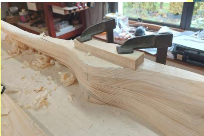
Les extrémités de pales sont mises à la cote et l'ensemble est finement râclé, puis poncé.
