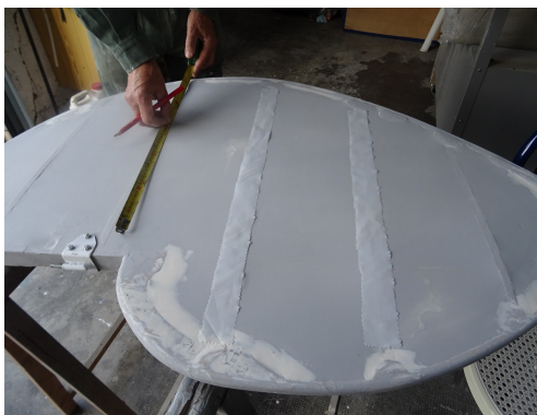
Gouvernes en cours de finition pour l'autogyre, ainsi qu'une console d'instruments de bord. Merci au club ULM d'Héric pour le boîtier de la console.
