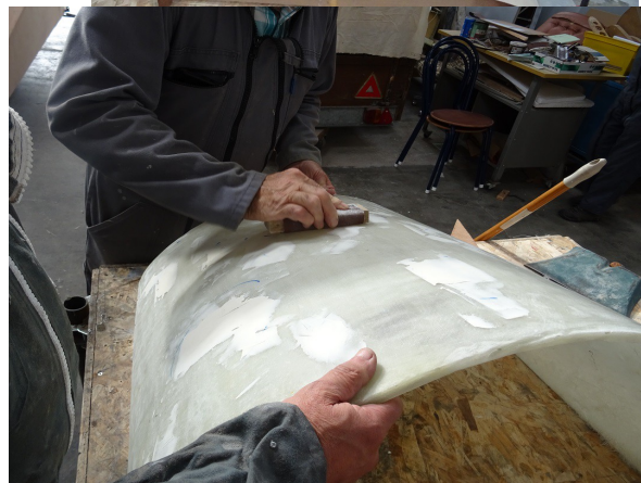
Ponçage des moules de verrière pour le DG 1
