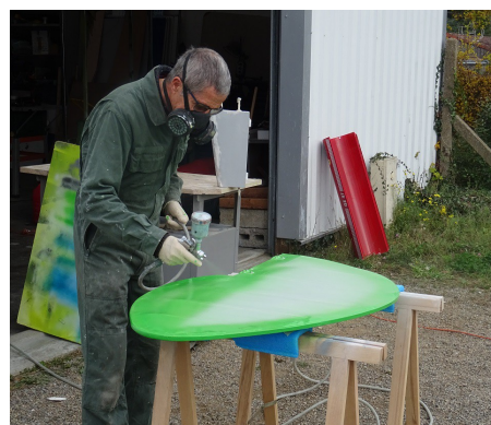
Gouvernes en cours de finition pour l'autogyre, ainsi qu'une console d'instruments de bord. Merci au club ULM d'Héric pour le boîtier de la console.
