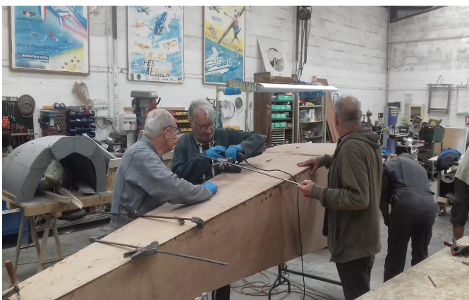
Ci-dessous : le fuselage et l'aile de l'avionnette PEYRET en cours de reconstitution.
