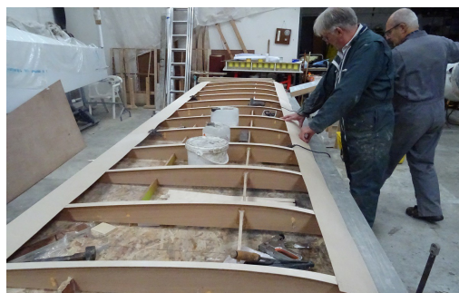
Ci-dessous : le fuselage et l'aile de l'avionnette PEYRET en cours de reconstitution.
