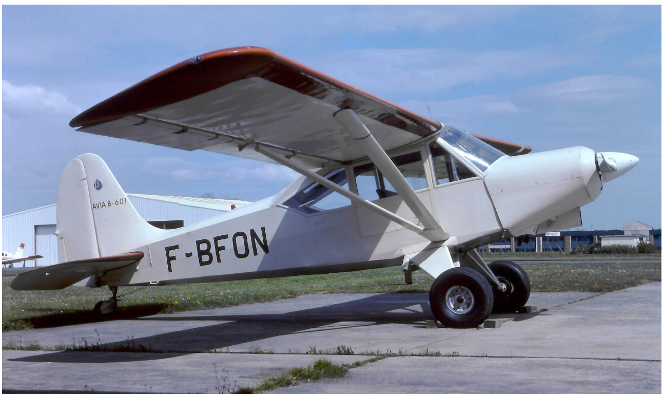
Ce quadriplace propulsé par moteur Lycoming O-360 180ch fut conçu à la fin des années 40 comme appareil d'usage général. Il ne fut construit qu'à 46 exemplaires toutes versions confondues.
