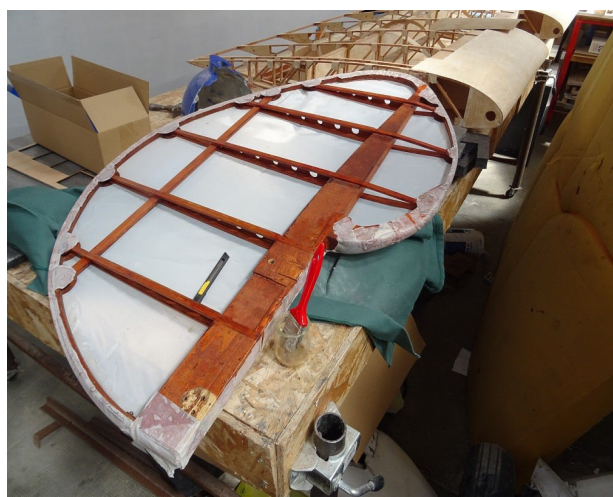
Une gouverne de direction en construction pour l'autogire.
