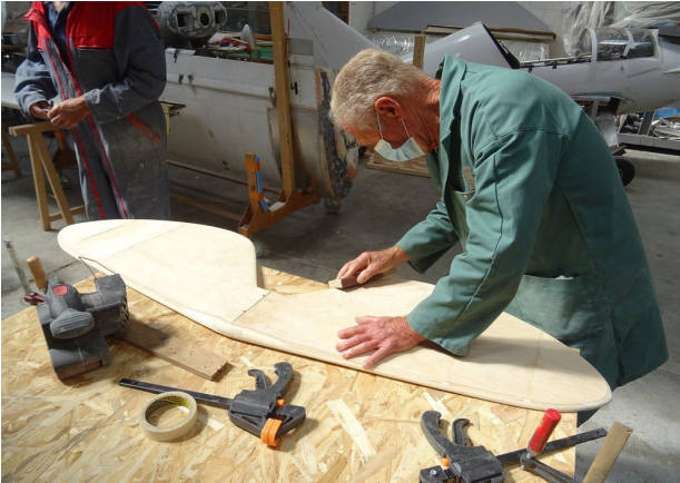
Construction d'un stabilisateur horizontal pour l'autogyre.
