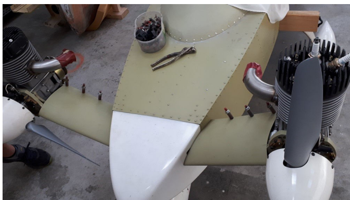
Travail sur les capotages des pylônes moteurs du Cricri.
