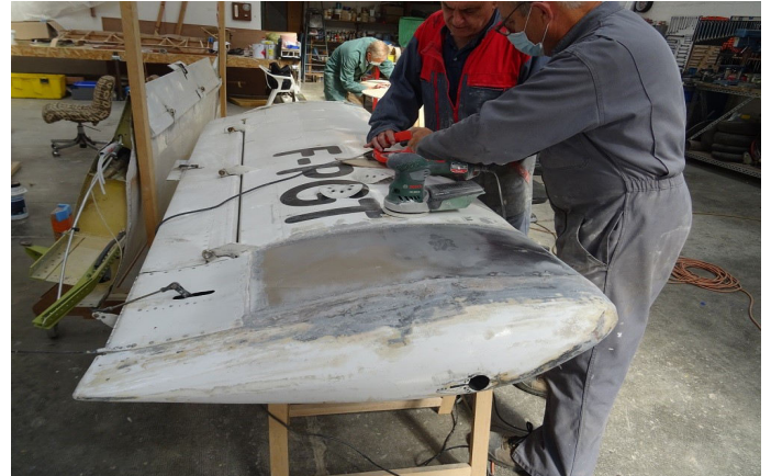
On avance un peu le travail de réparation du DG1
