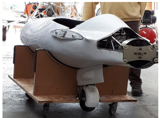
Le fuselage du CC-01 sur son berceau à roulettes.
