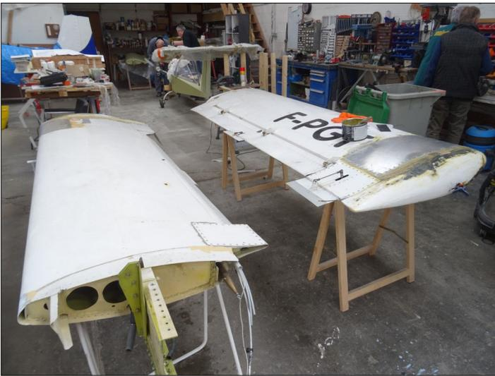
*Les ailes du DG 1, avec les travaux de tôlerie conséquents.*
