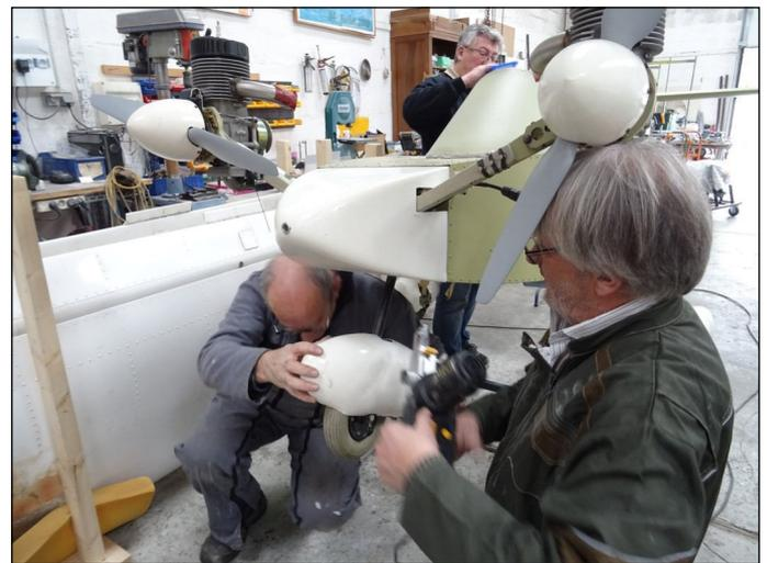
*Montage des carénages de roues sur le Cri-cri.*
