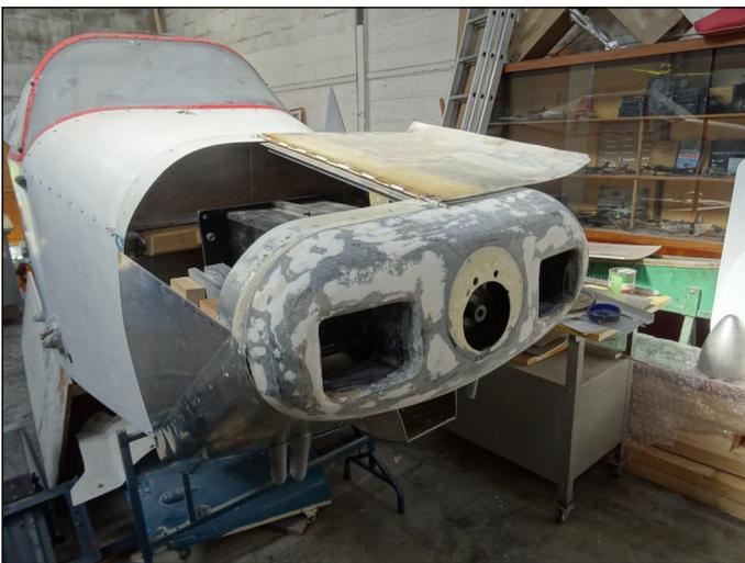
*Les capots du RL 19 réalisés et ajustés*
