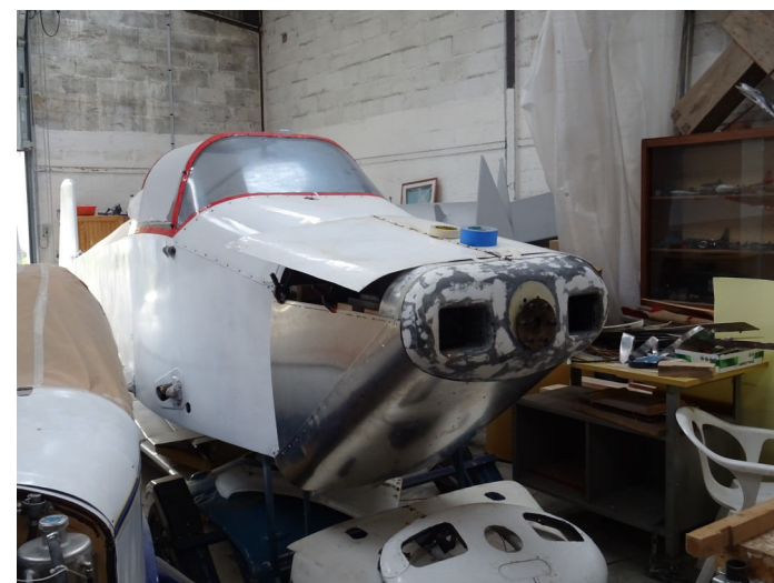
Le RL 19 a reçu une verrière neuve, et les capots sont en cours de fabrication.
