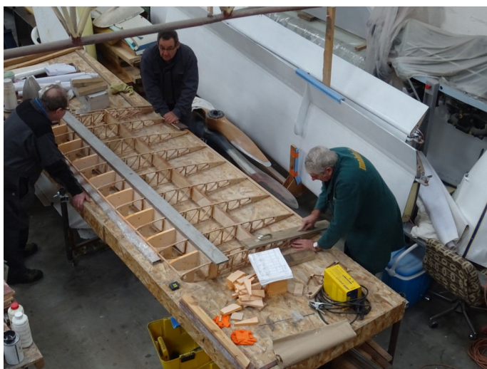
L'aile du HM 293 en construction commence à prendre forme, sous la houlette de Bernard.
