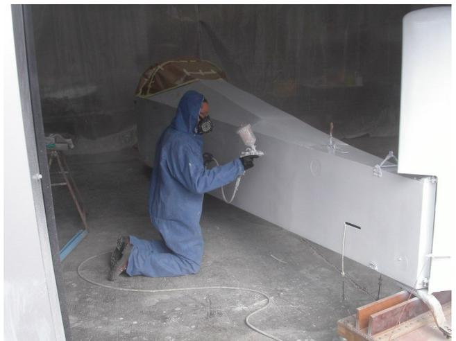
Le poste de pilotage du RL 19 a été rénové (peinture, planchers, instruments de bord, moquettes), et le fuselage peint en blanc, ainsi que les gouvernes de direction et de profondeur. Il restera à refaire des sièges.
