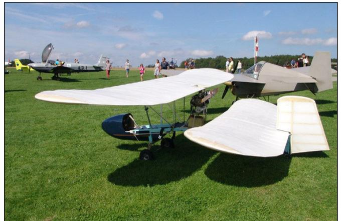
Plus tard, le châssis est fortement modifié : des tubes d'alu carrés soudés remplacent les pièces en tôle pliée assemblées par rivets pop. Le Butterfly prend le nom de Bifly lors de la reprise de l'entreprise BN (Brugeoise et Nivelles) par les Ets Lascaud.
