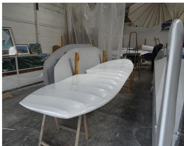
Sous couche sur le fuselage du BUTTERFLY. L'une des ailes a pu être peinte, l'aile principale est en finition.
