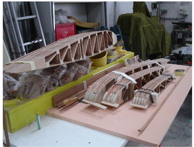
L'atelier "nervures" du HM 293. C'est du sérieux ! Le stock de nervures construites l'atteste. La fabrication des longerons va pouvoir commencer.
