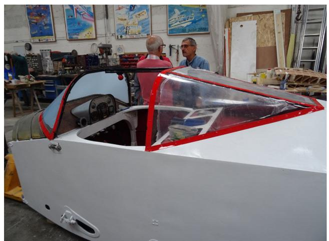
Un ultime travail de finition sur les ailes du RL 19 s'est imposé avant la prochaine mise en peinture. Par ailleurs, la verrière a été reconstruite à neuf et les arceaux repeints en rouge.
