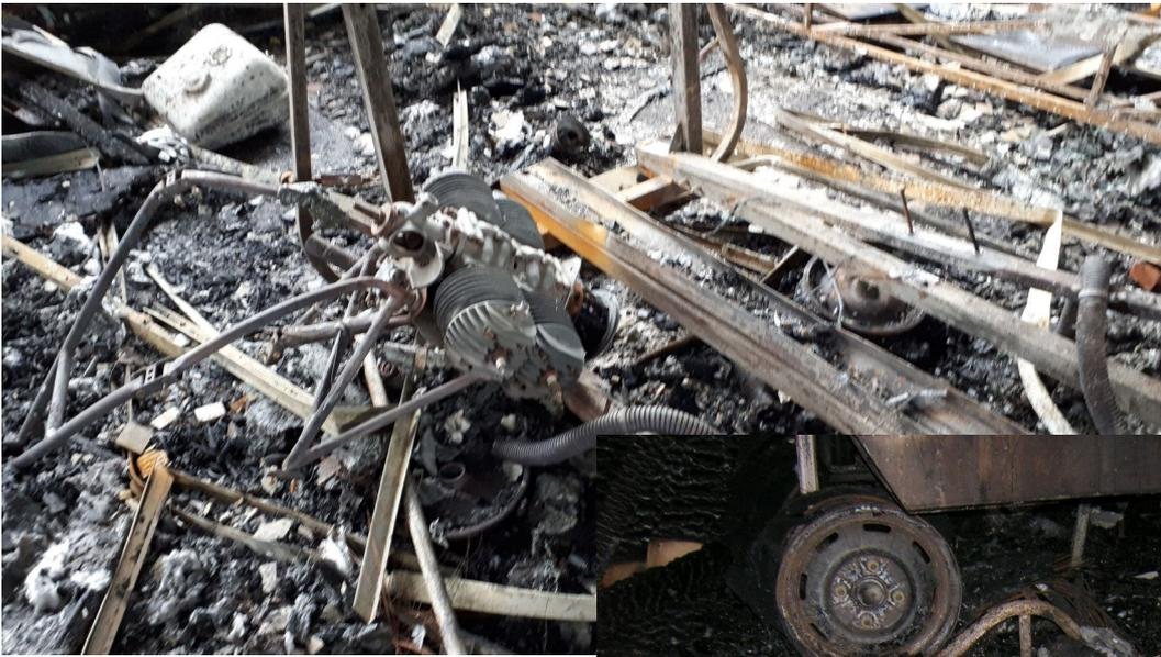
Restes du HM 14 de 1935 et de sa remorque. Dans l'amas de ferraille le moteur AVA partiellement fondu.
