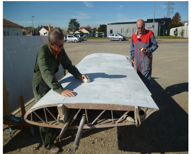
Ponçage et rebouchage, encore et toujours au vu du mauvais état des revêtements.
