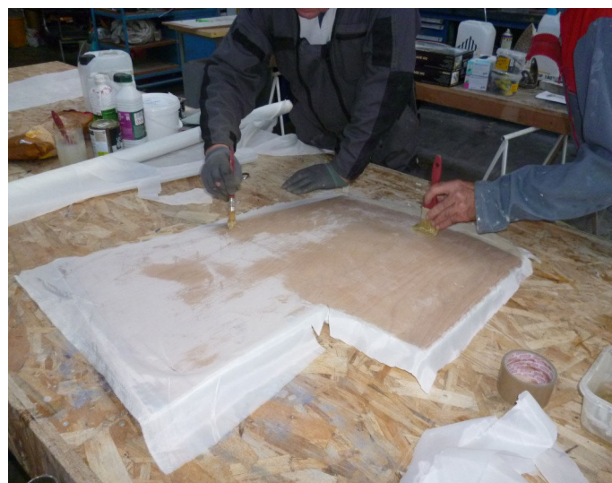
Travaux sur les structures d'ailes du BUTTERFLY : fabrication des saumons d'ailes et rectification des chapeaux de nervures en stratifié.
