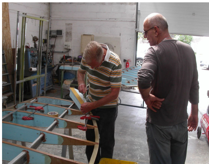
Travaux sur les structures d'ailes du BUTTERFLY : fabrication des saumons d'ailes et rectification des chapeaux de nervures en stratifié.
