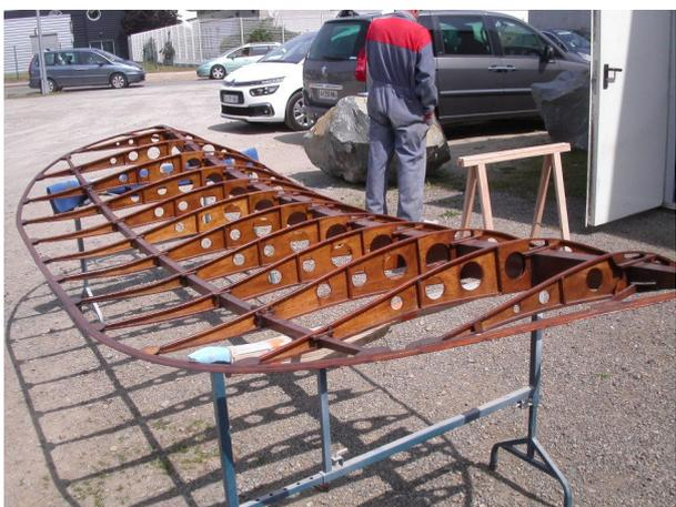
*L'aile du HM14 en cours de réparation après la casse accidentelle d'une nervure .*
