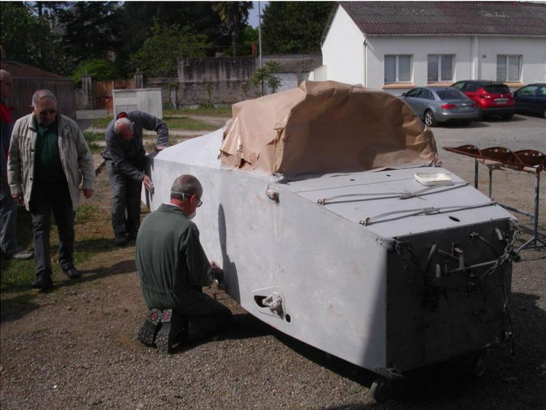
*Le fuselage entièrement poncé, mastiqué et enduit, avant mise en peinture.*
